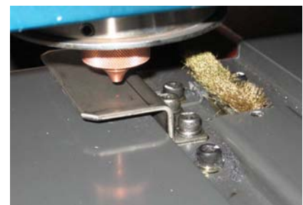
Station automatique de calibration et de nettoyage de la buse
